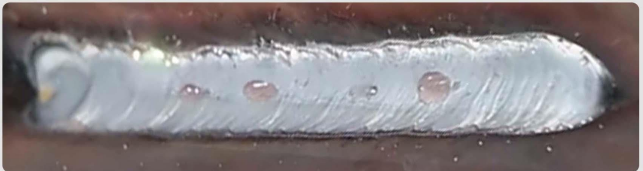
Pulso doble: rendimiento de soldadura de acero al carbono de 6 mm
