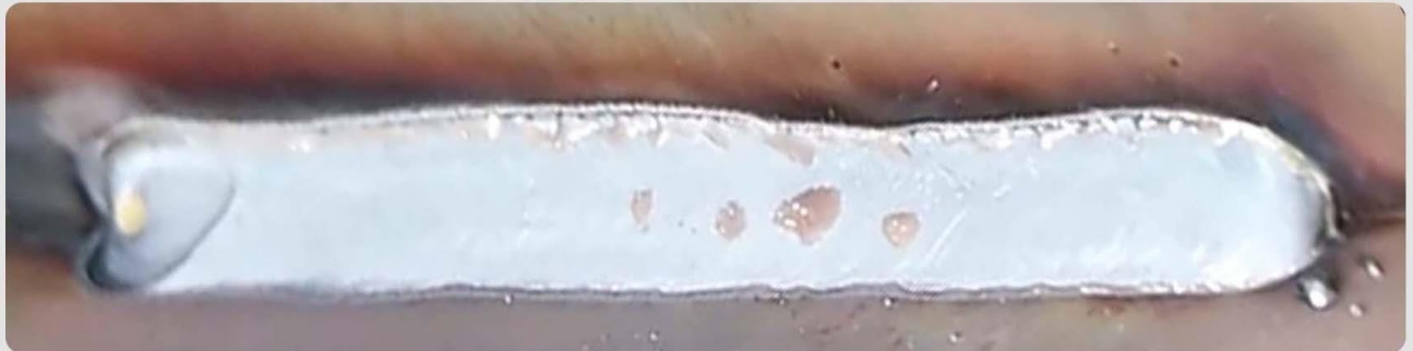
Pulso simple: rendimiento de soldadura de acero al carbono de 6 mm
